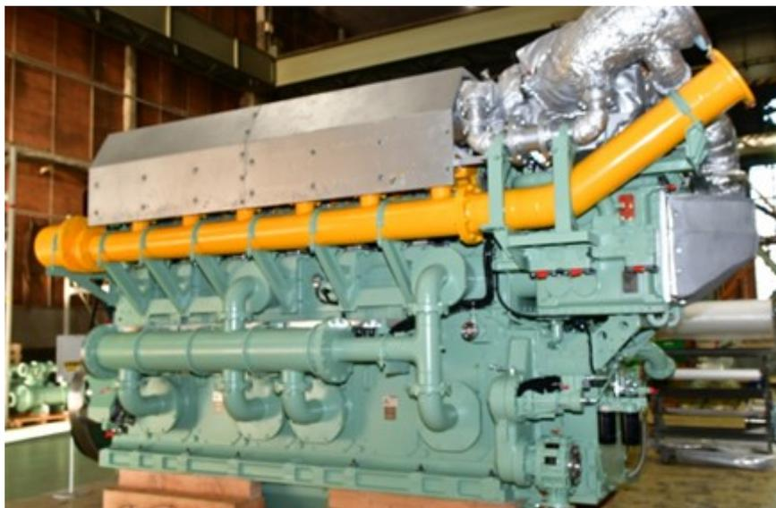
A-Tug用中速4ストローク28ADF型エンジン（出力：1618kW/台
