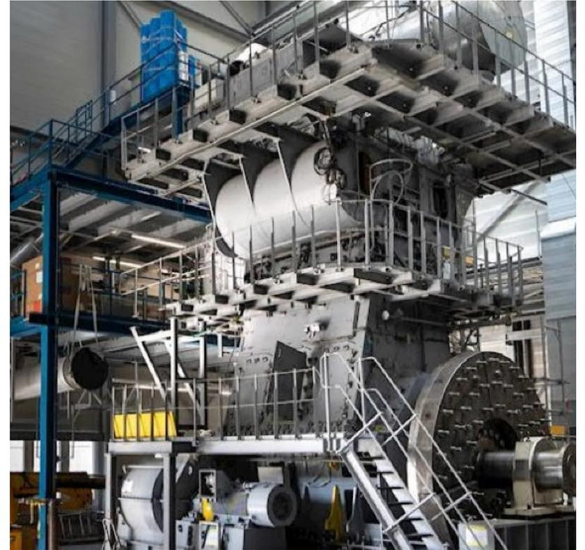
WinGD 社の低速2ストローク・アンモニアエンジン開発のための単気筒テストエンジン
