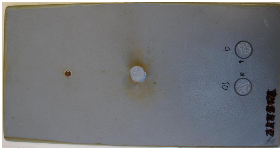
図 C-1 ウェーブタンク試験の底板試験片における人工塗膜欠落からの剥離 (このモデル報告書の結果例は写真例と関係ない)
