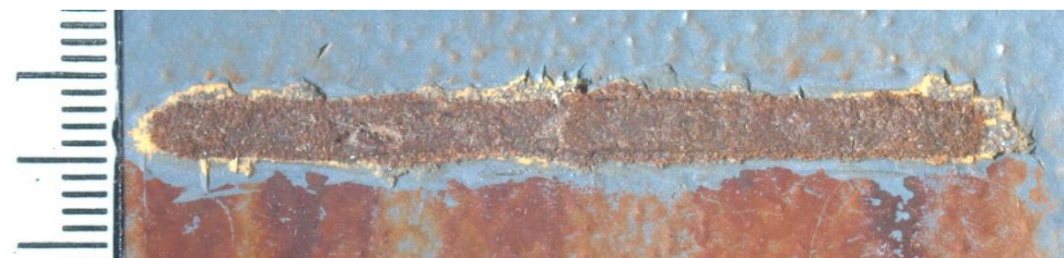
図 C-5 ウェーブタンク試験の側面試験片におけるスクライプからのさび幅 (冷却なし) (このモデル報告書の結果例は写真例と関係ない)
