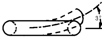
図 B12.5.2-2. リンクの曲がり計測
