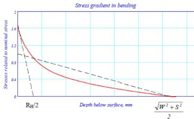
図 2 深さの関数としてのクランクピンすみ肉部の曲げの応力集中係数
