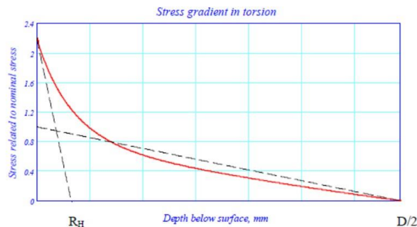
図 3 深さの関数としてのクランクピンすみ肉部のねじり応力集中係数
