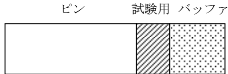
図 L3.5 延長したピンの試験片採取位置
