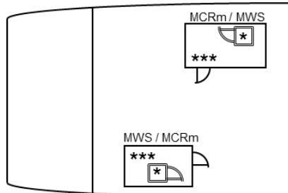
(1) 機関制御室及び主作業室から垂直トランクを使用し、機関区域外へ脱出する配置
