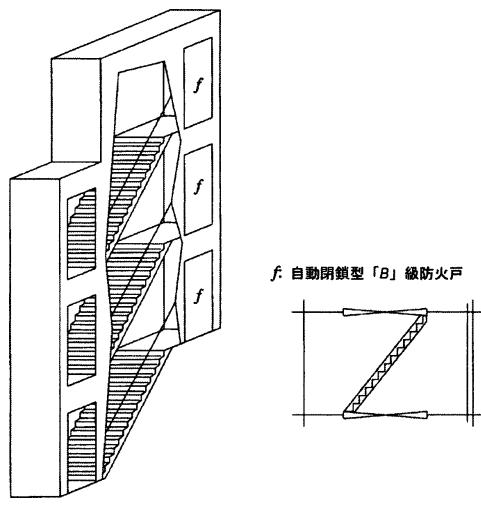
階段のみをトランクで囲み、甲板ごとにトランク外に出る構造
