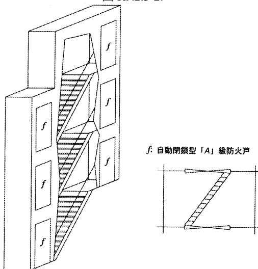
*f: 自動閉鎖型「A」級防火戸*階段のみをトランクで囲み、甲板ごとにトランク外に出る構造
