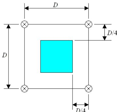
D : 消火試験により認められた消火ノズルの最大間隔
