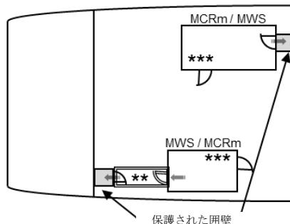
(2) 機関制御室及び主作業室から直接又は水平トランクを経由し、保護された隔壁を使用して機関区域外へ脱出する配置
