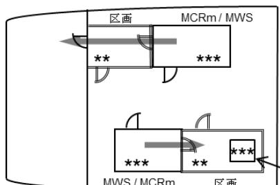
(5) 機関制御室及び主作業室以外の区画を経由し、直接又は垂直トランクを使用して機関区域外へ脱出する配置
