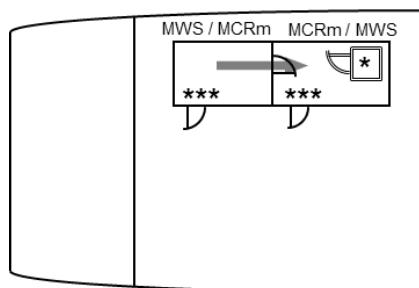
(3) 隣接する機関制御室又は主作業室を経由し、垂直トランクを使用して機関区域外へ脱出する配置
