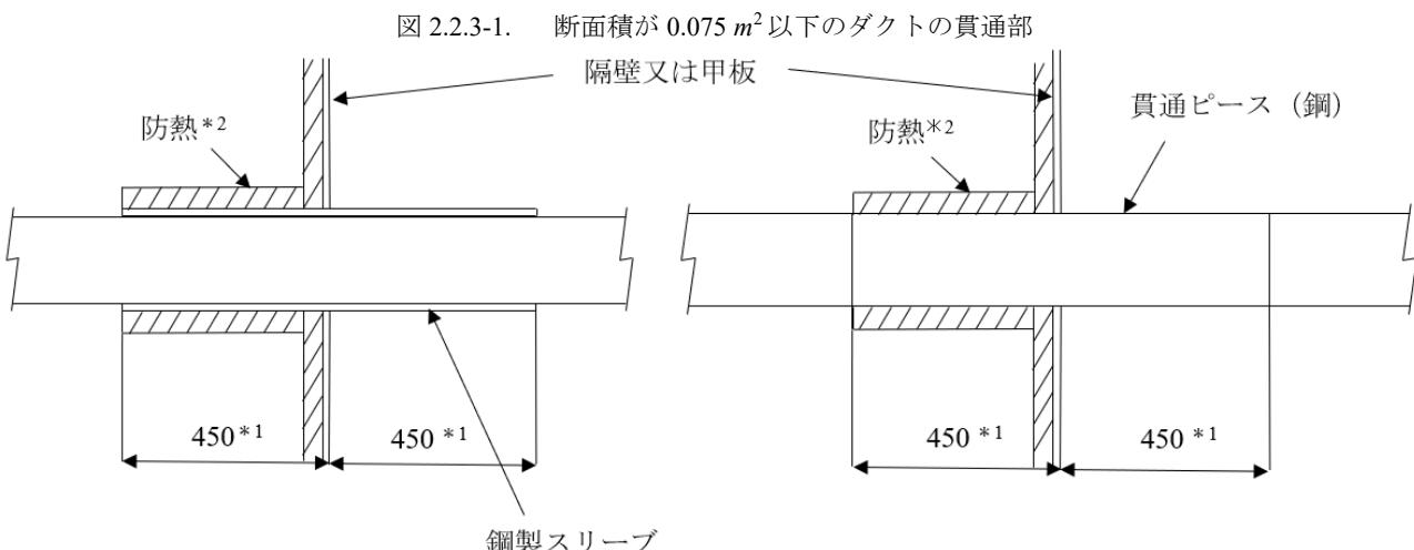
\*1 断面積が  $0.02\ m^2$  以下のダクトであって、金属管のような熱伝導性の良い材料ではないものの場合、防熱は**2.2.1**で規定する鋼製スリーブ及び貫通ピースの範囲までとして差し支えない。
