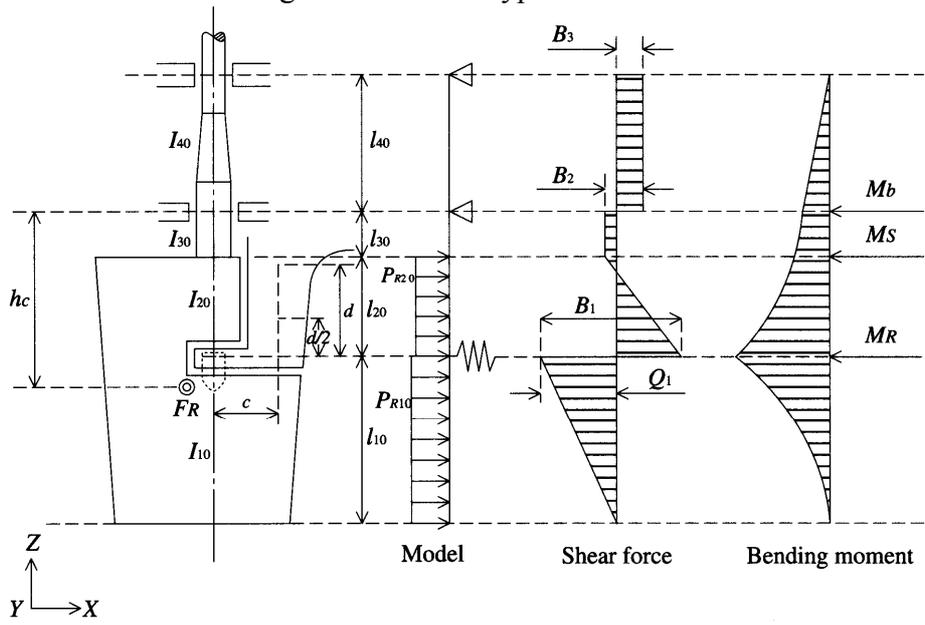
Fig. C3.4.1-5 Type E Rudder
