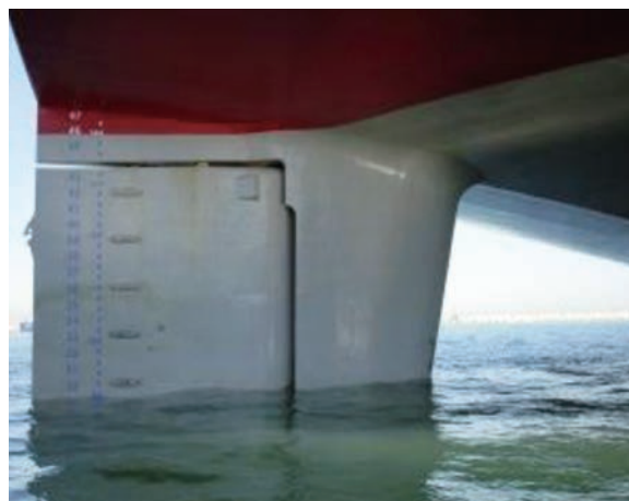
図8 舵が完全に没水しない状態の例
