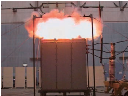
図22 内部アーク短絡試験の様子 (JRCS株式会社提供)
