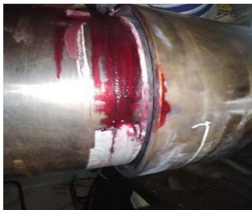
図2 プロペラ軸の即時交換が必要な最近の事例
