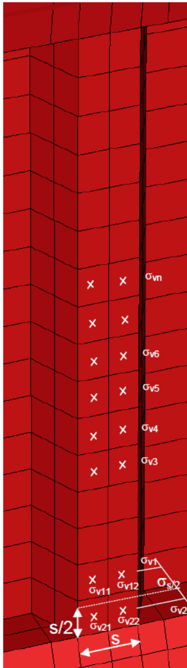
図 PR2 垂直波形隔壁のフランジパネル座屈における要素応力の平均方法及び補間方法
