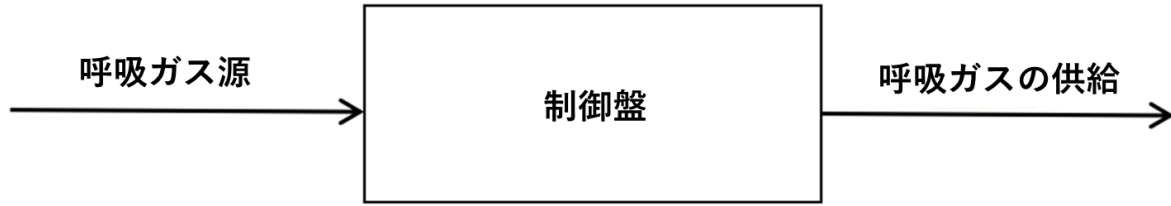
図 5.12.2-1. 「呼吸ガス源」及び「呼吸ガスの供給」のイメージ
